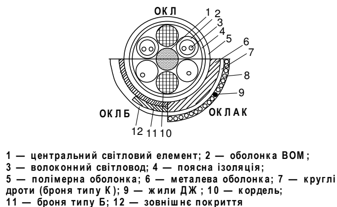
Рис. 5.15 – Конструкції кабелів типу ОКЛ
