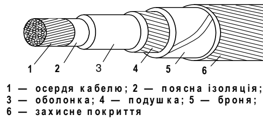
Рис. 5.11 – Загальний вигляд кабелю з захисними покриттями
