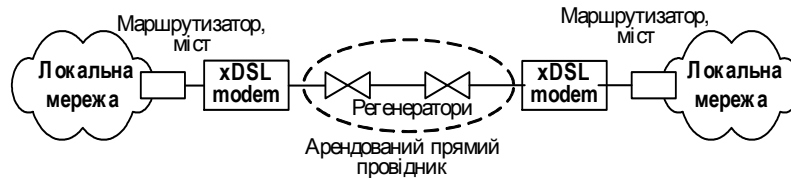
Рис. 2.18 – Застосування технологій xDSL для об'єднання локальних мереж
